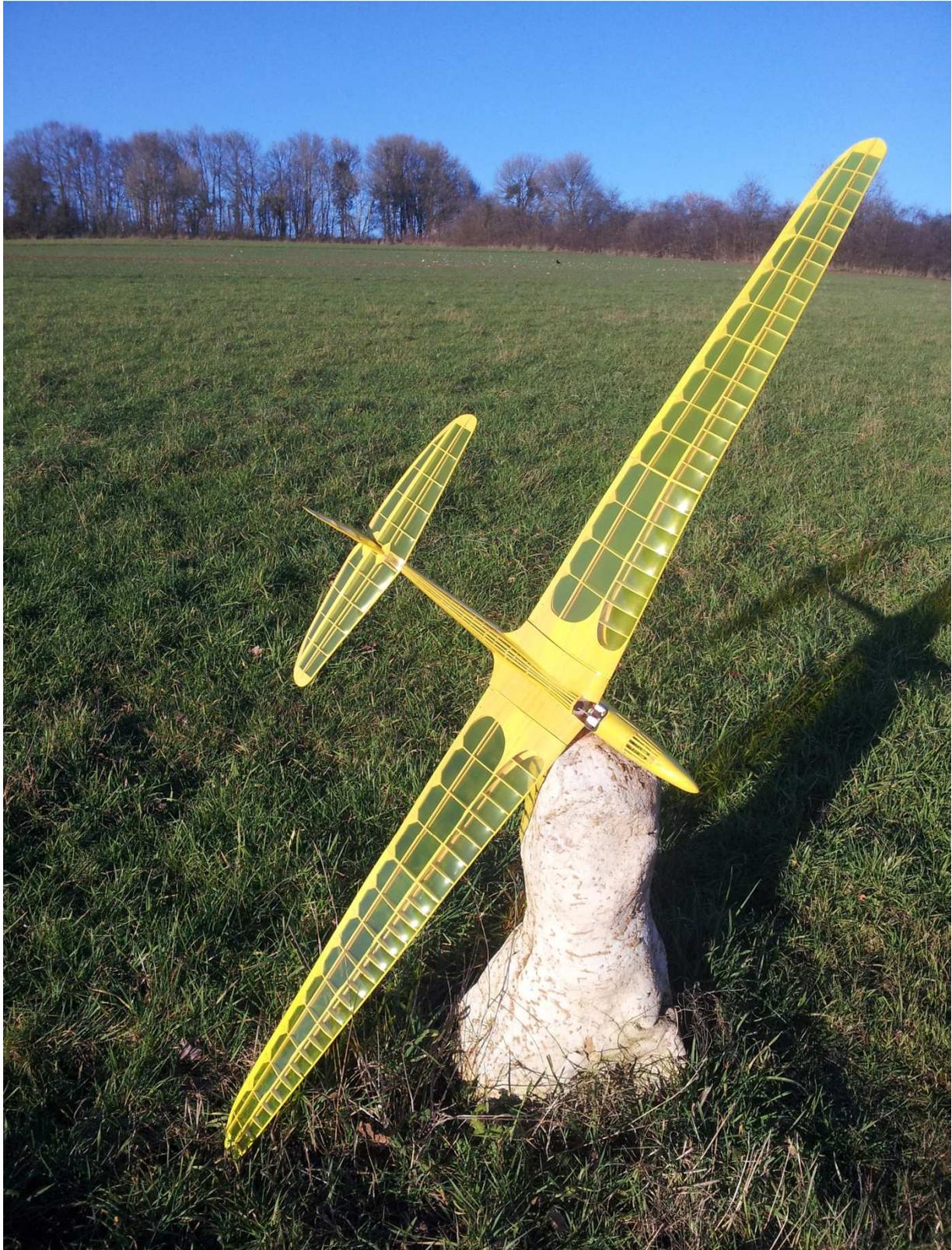
Réplique du planeur de vol libre des années 40. Celui qui vous est présenté ici a été remis au goût du jour et adapté à la radiocommande. Le pilotage sur les 3 axes assure une manœuvrabilité exemplaire pour ce genre de machine permettant de virer dans un mouchoir de poche.
